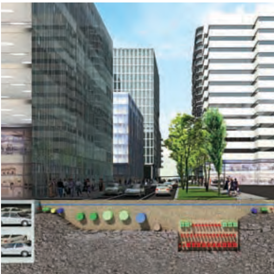
Afb.13 Bundeling van kabels en leidingen – Vivaldi, Zuidas Amsterdam
