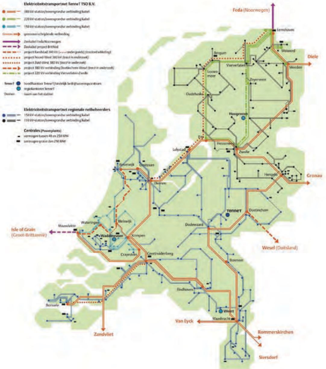
Afb.6 Hoofdtransportnet voor elektriciteit
