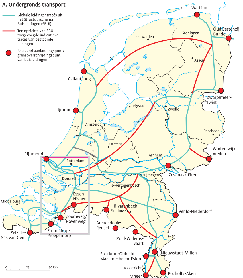
Afb.2 Industrieel buisleidingtransport in Nederland
