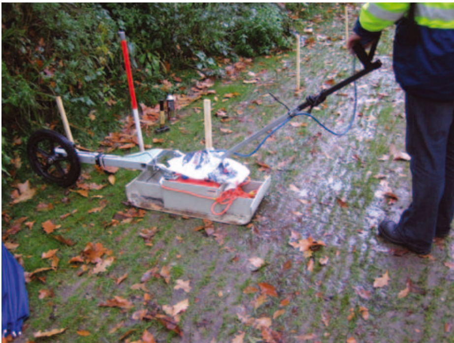
Meting met grondradar met een enkel-kanaalsysteem, het meten van afzonderlijke meetlijnen.
