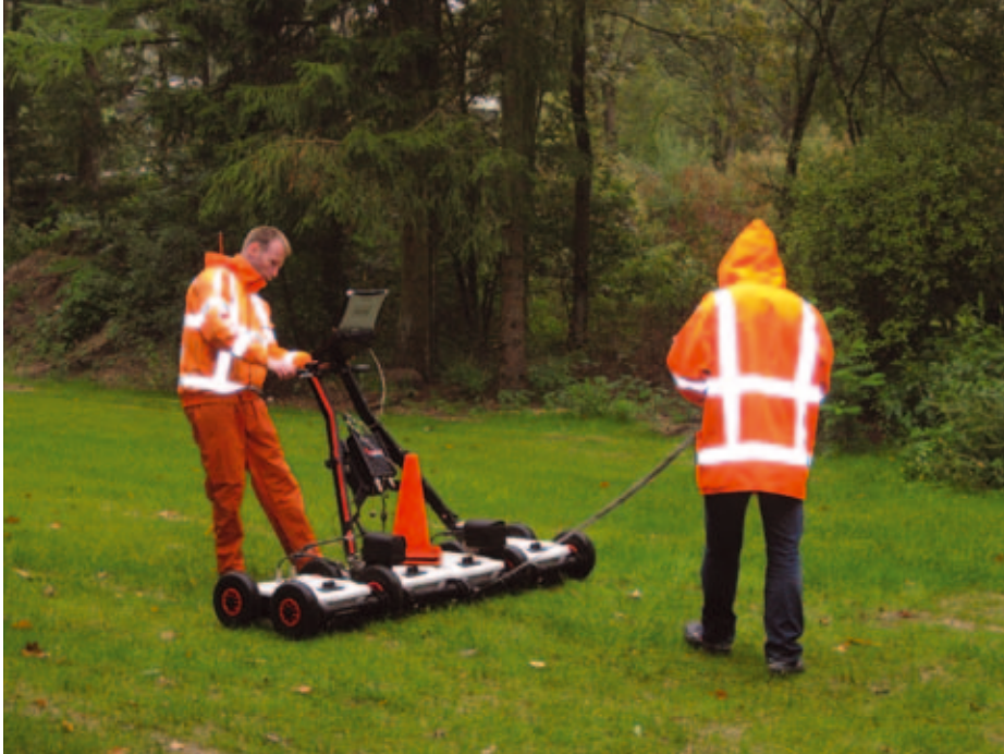
Meting met grondradar middels een meer-kanaalsysteem waarbij over de volle breedte 3D-data wordt verkregen.
