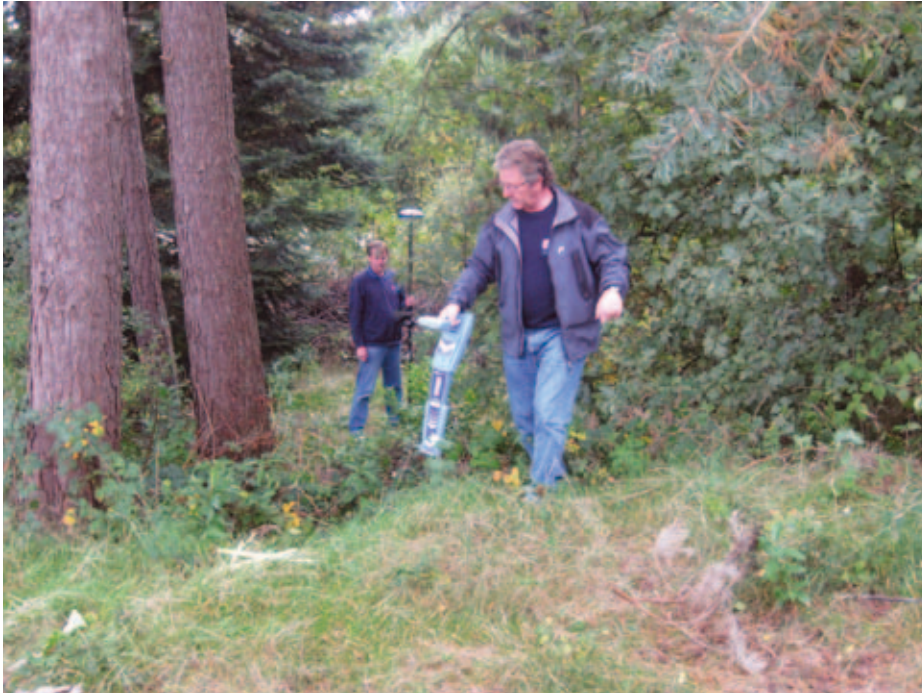
Onderzoek met radiodetectiesysteem waarbij de detectiemarkeringen direct worden vastgelegd door een landmeter.
