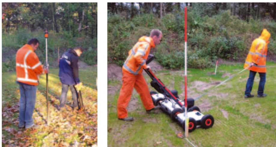
FIGUUR 11. Uitvoering van de test met radiodetectie (links) en grondradar (rechts).
