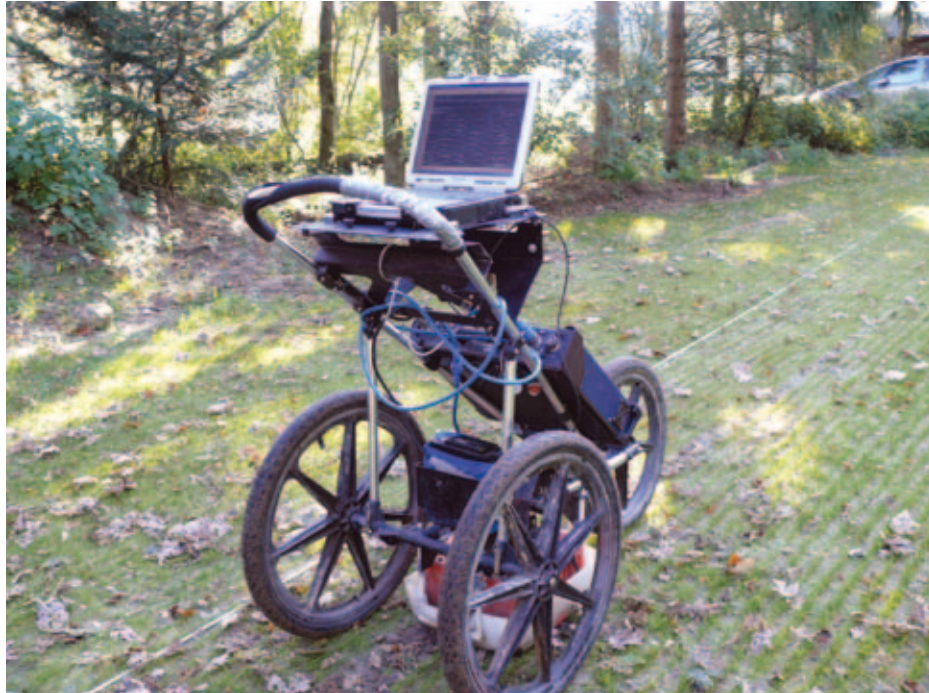
Weergave van een grondradar-kart.
