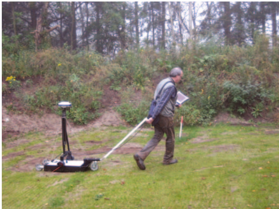
Grondradar (groundtracer) gecombineerd met GPS.
