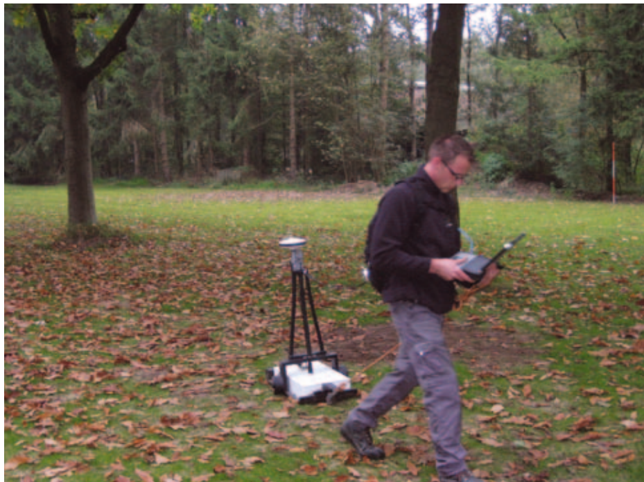
Het meten met grondradar (groundtracer) gecombineerd met GPS.
