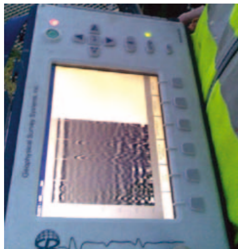
FIGUUR 21. Radarpatronen die de veldwerker moet interpreteren bij grondradaronderzoek. De parabolen op het scherm zijn gevonden objecten.
