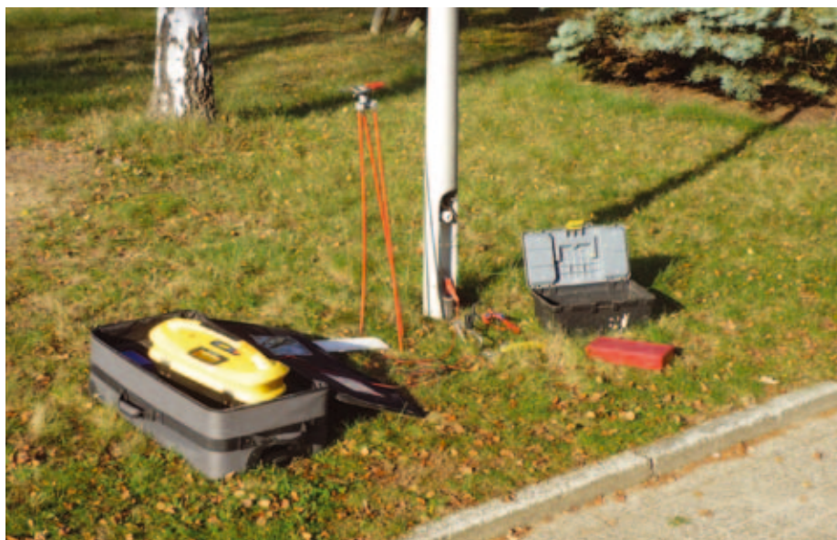
FIGUUR 22. Het aansluiten van radiodetectie op een lantaarnpaal, zodat een uniek signaal op de te zoeken kabel wordt geplaatst. Op deze wijze kan een metalen kabel eenvoudig worden teruggevonden, zelfs wanneer deze zich in een bundel bevindt.
