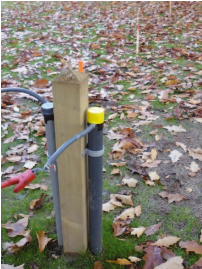
FIGUUR 6. In Testveld 1 zijn metalen kabels tot boven de grond uitgevoerd om signaal te kunnen plaatsen voor radiodetectie.
