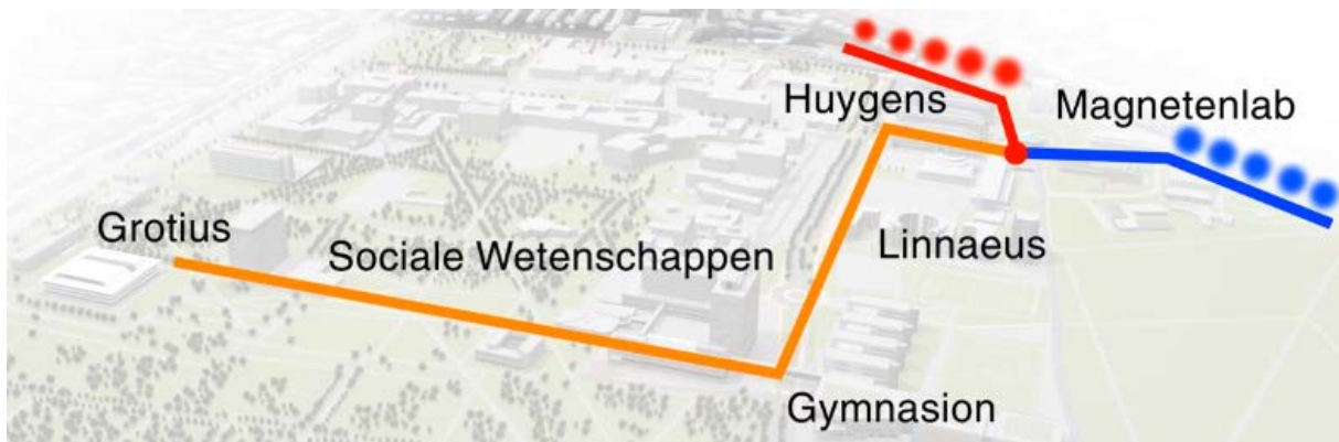
Figuur 32: Overzicht van het WKO-systeem Radboud Universiteit (collectief doubletsysteem)
