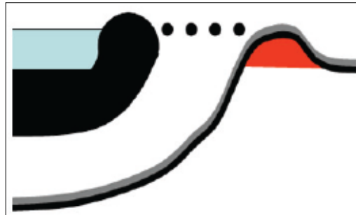
Figuur 21 Schematische werking kanteldijk
