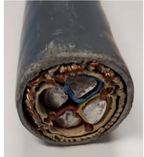
Figuur 37: Laagspanningskabel (Bron: Eigen foto)
