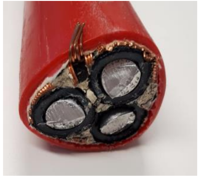
Figuur 35: Modernere middenspanningskabel 3x 240mm (Bron: Eigen foto)
