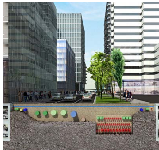
Figuur 8.2 Bundeling van kabels
