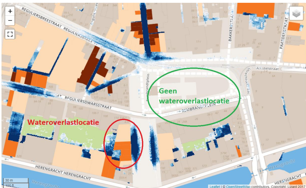
Figuur 19: Het verschil tussen een wateroverlastlocatie en geen wateroverlastlocatie
