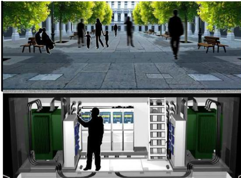
Figuur 34: Een ICEBERG ondergronds algemeen voedingspunt, ventilatieroosters in het maaiveld
